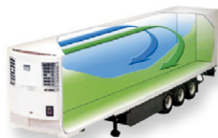
Naczepa chłodnia, z możliwością jednoczesnego przewozu towaru mrożonego i schłodzonego
