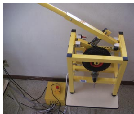
Półaktywny System Zawieszenia z tłumikiem magneto-reologicznym produkcji INTECO
