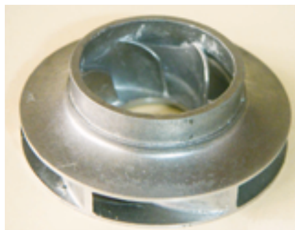
Rys. 4. Odlewy wirnika pompy. Wirnik otwarty i kompletny
