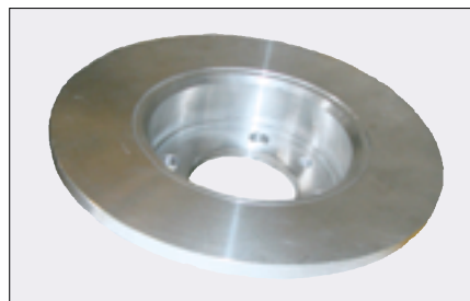
Rys.5. Fotografia prototypowej tarczy hamulcowej wykonanej z kompozytu ALFA (widok z obu stron) do krajowego samochodu osobowego marki Polonez
